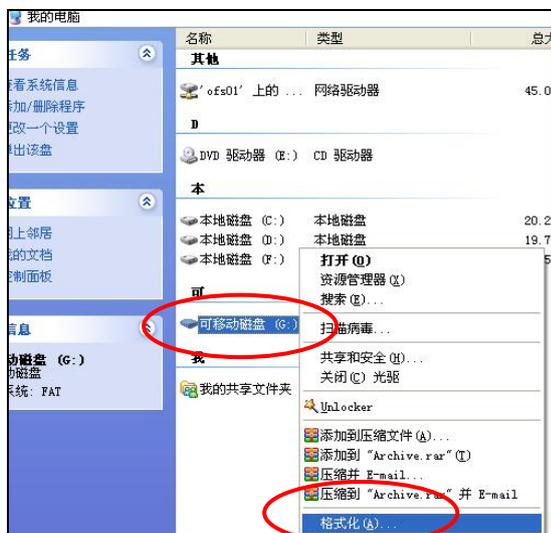
c. 弹出选择框（如下图），然后从文件系统中选择“FAT32”，确认后点击“开始”按钮，对 SD 卡进行格式化。
